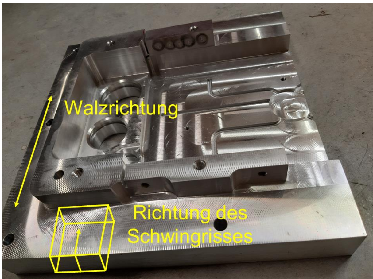
Bild 1: Übersicht Bauteil Legierungsvariante C mit Walzrichtung und Entnahmerichtung der Proben mit Richtung des Schwingrisses.
