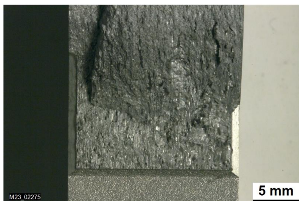
Bild 30: Probe 1 Makroaufnahme. Das Ende des Schwingriss ist nicht zu identifizieren.
