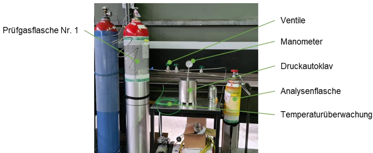
Bild 10: Aufbau Prüfstand für Auslagerung der Proben in feuchtem Wasserstoff
