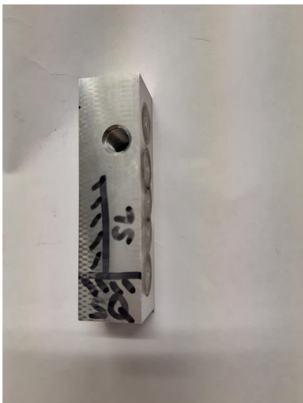
Bild 2: Abschnitt des Bauteils zur Bestimmung der Walzrichtung. Eingezeichnet ist der Querschliff (SQ) und der Längsschliff in (SL) Bezug auf den Abschnitt
