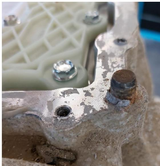
Abbildung 9: Angeraute und mit Resten der Dichtmasse versehene Dichtflächen sowie korrodierter Passstift
