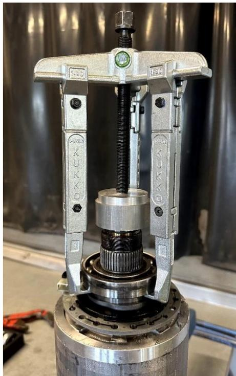
Abbildung 27: Demontage des auf die Rotorwelle aufgepressten Radialkugellagers auf Seite der E-Maschine
