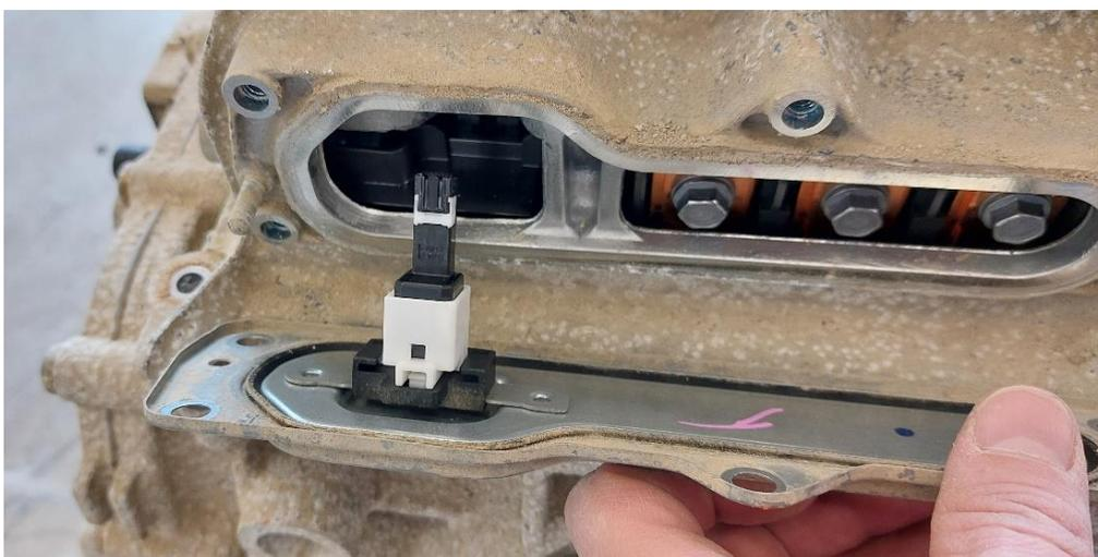
Abbildung 7: Demontierter Deckel der Stromschienen bei der Verbindungsstelle von elektrischer Maschine und Leistungselektronik
