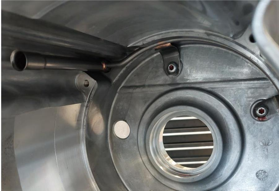
Abbildung 38: Ölrohr im Hauptgehäuse. Einbaulage hinter dem Stator.
