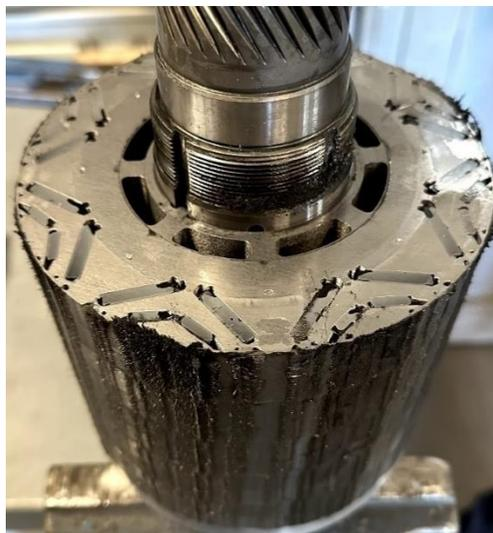
Abbildung 32: Elektroblechpaket mitsamt eingeklebten Permanentmagneten
