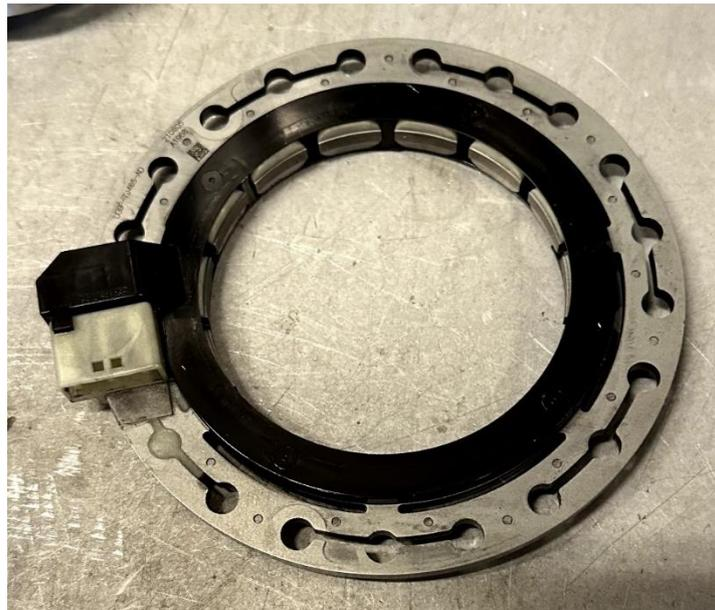
Abbildung 28: Äußerer Teil des Drehzahlgebers
