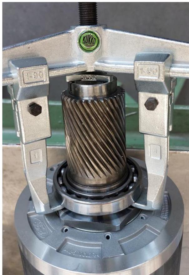
Abbildung 25: Demontage des getriebeseitigen Radialkugellagers vom Rotor mittels eines dreiarmligen Lagerabziehers
