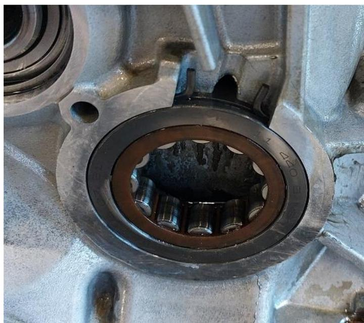
Abbildung 60: Lager der Zwischenwelle im Hauptgehäuse. Sichtbar sind im oberen Bereich die Enden des Sicherungsrings
