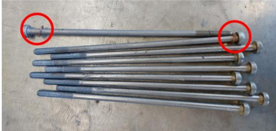
Abbildung 62: Gehäusespannschrauben. Rot markiert zwei Kupferscheiben.
