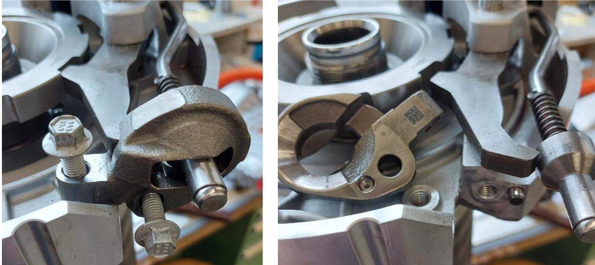
Abbildung 22: Halteelement der Parksperre mit gelösten Schrauben (links) sowie Sicht auf teildemontierte Parksperre mit ausgefederter Sperrklinke
