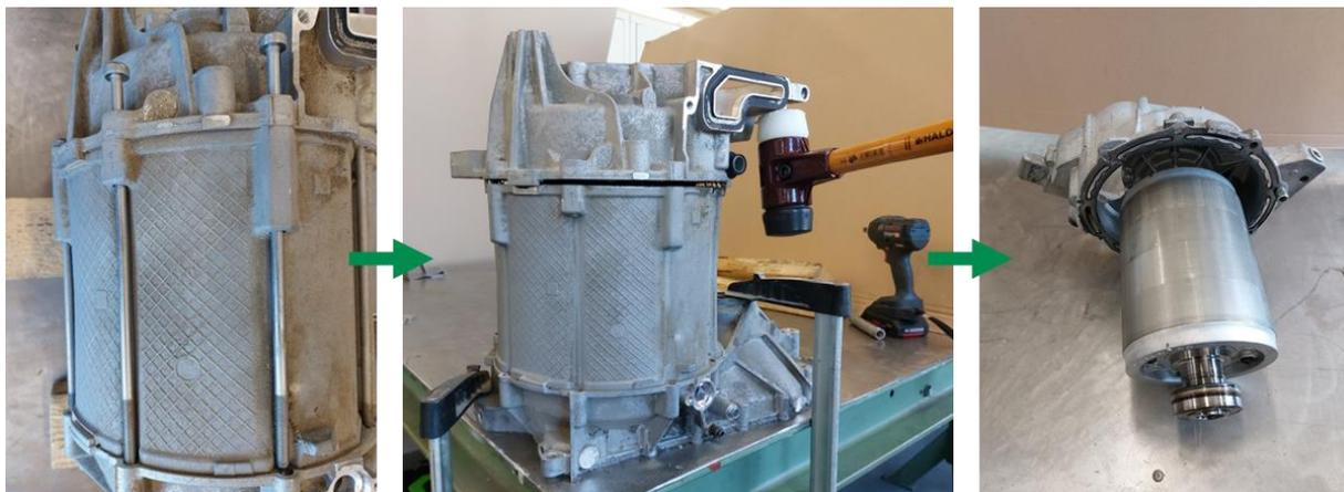
Abbildung 63: Öffnen des Hauptgehäuses: Demontieren der Spannschrauben (links), Trennen der Gehäuseteile (Mitte), Ziehen des Gehäuseteils der elektrischen Maschine (rechts). In diesem Fall verblieb der Rotor im Lager seitens der elektrischen Maschine.
