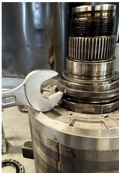
Abbildung 29: Abhebeln des inneren Teils des Drehzahlsensors und des davor aufgepressten Spannringes
