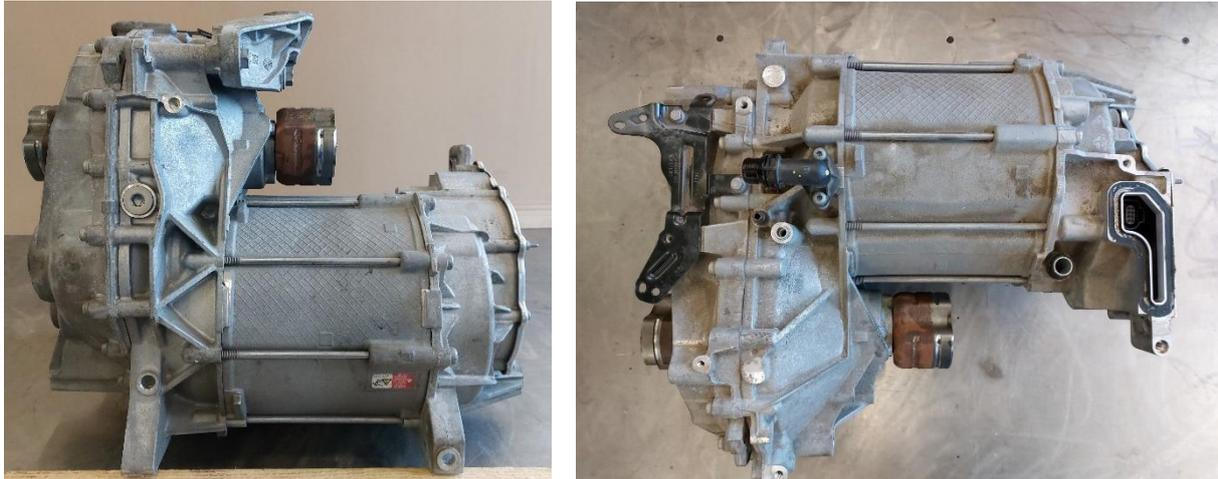
Abbildung 40: Das ID.4 Antriebsaggregat im Anlieferungszustand (links Untersicht, rechts Draufsicht)
