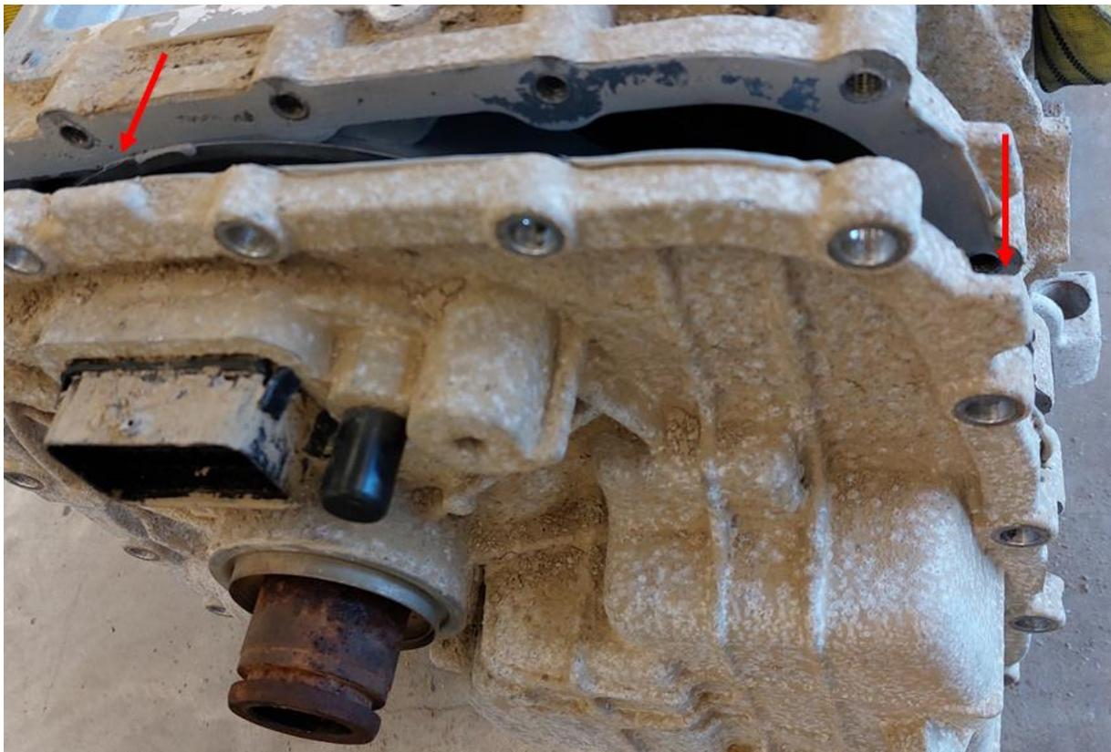
Abbildung 15: Leicht abgehobener E-Maschinendeckel zur Demontage des Elektrosteckers. Rote Pfeile verweisen auf einen Schlagpunkt (links) sowie einen Konterpunkt (rechts).
