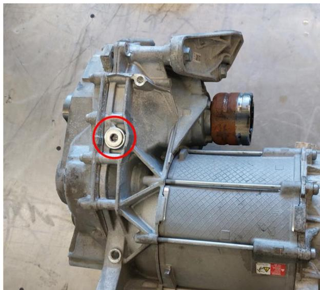
Abbildung 42: Blindstopfen zum Ablassen des Getriebeöls am ID.4 Aggregat (rot markiert)
