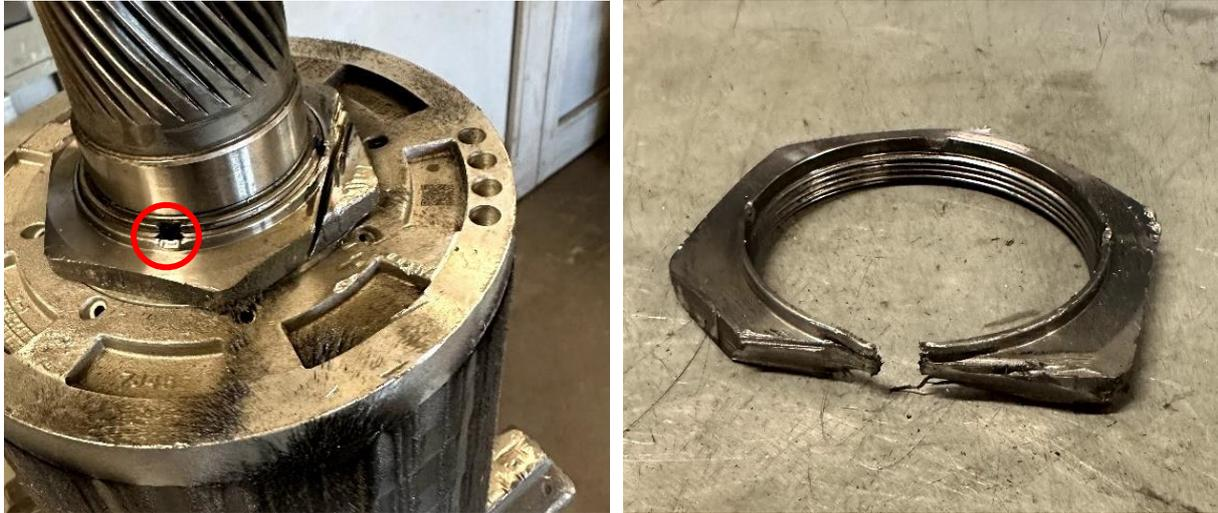
Abbildung 31: Flachmutter der Rotorwelle während der Demontage mittels eines Winkelschleifers mit erheblicher Verschmutzung des Rotors durch Metallstäube (links), rot umrandet: eine der vier als Rotationssicherung vorgesehenen Eindrücke). Rechts: Demontierte und zerstörte Flachmutter nach erfolgter Demontage
