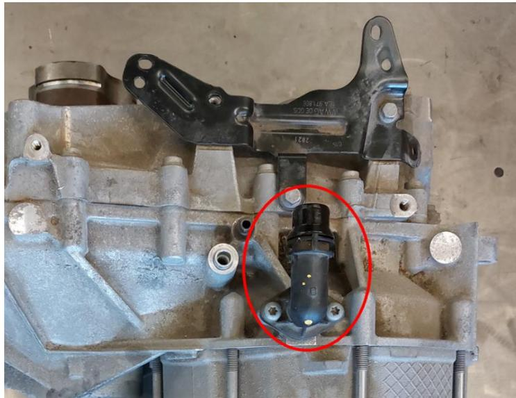
Abbildung 45: Kühlmittelstutzen (gewinkelt)
