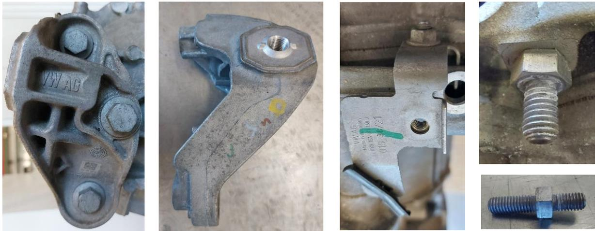
Abbildung 43: Peripher zu demontierende Komponenten am ID.4 Aggregat: Motoraufhängung (links) und Kabelhalterung (rechts)
