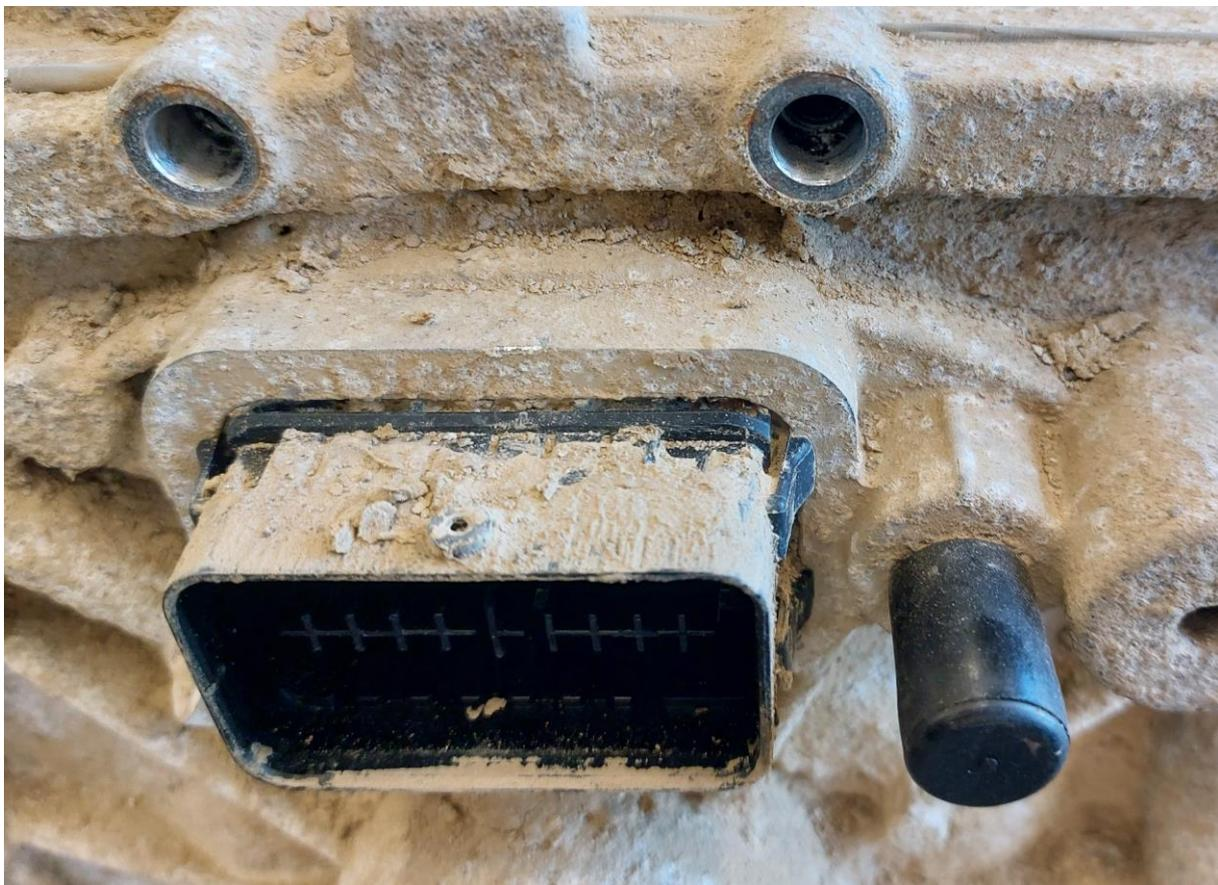
Abbildung 16: Nahaufnahme des stark verschmutzten Elektrosteckers im E-Maschinendeckel. Gut zu sehen sind die Verriegelungen
