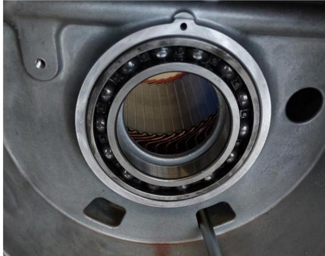
Abbildung 36: Zugänglichkeit zum Stator zwecks Entnahme aus dem Hauptgehäuse. Getriebeseitige Ansicht. Die Kontaktflächen für ein potenziell zu entwickelndes Zugwerkzeug sind sehr begrenzt, weshalb eine Entnahme ohne Beschädigung trotz geringen notwendigen Kraftaufwandes fraglich erscheint. Nach der manuellen Demontage konnten auf der Außenseite des Blechpaketes Schleifspuren festgestellt werden. Der Stator ist nach Entnahme nicht tiefergehend zerstörungsfrei zu demontieren.
