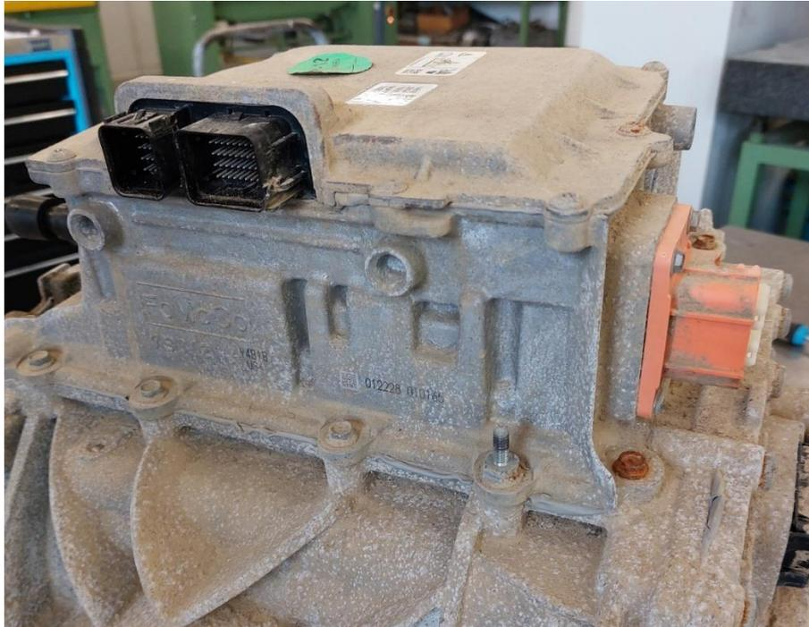
Abbildung 6: Leistungselektronik des E-Transit Antriebsaggregats
