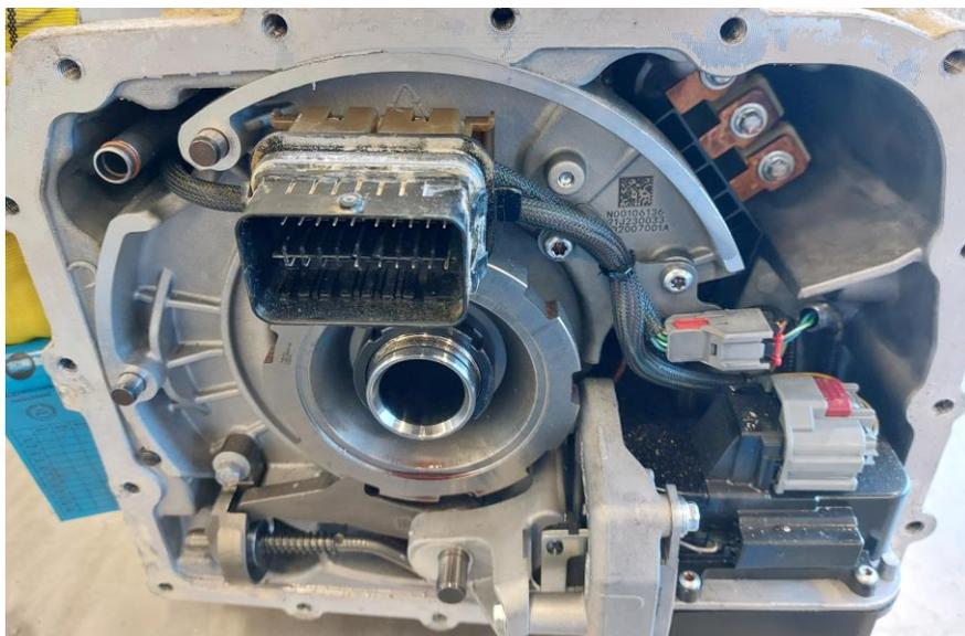
Abbildung 18: Sicht auf das Aggregat nach Entfernen des E-Maschinendeckels
