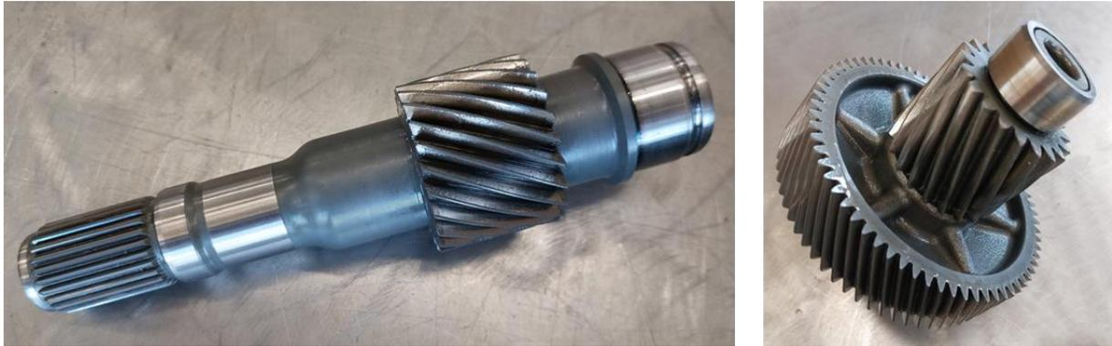
Abbildung 57: Demontierte Getriebezahnräder: Abtreibendes Zahnrad des Rotors (links) sowie Zwischenwelle (rechts)
