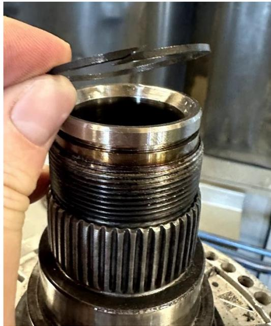
Abbildung 30: Stahlring aus der Umlaufnut an der Rotorwelle
