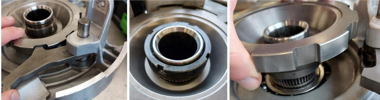
Abbildung 24: Sperrklinke am Parksperrenrad (links), zentrale Nutmutter zur Befestigung des Parksperrenrads (Mitte), Demontage des Parksperrenrads an von der Korbverzahnung der Rotorwelle (rechts)
