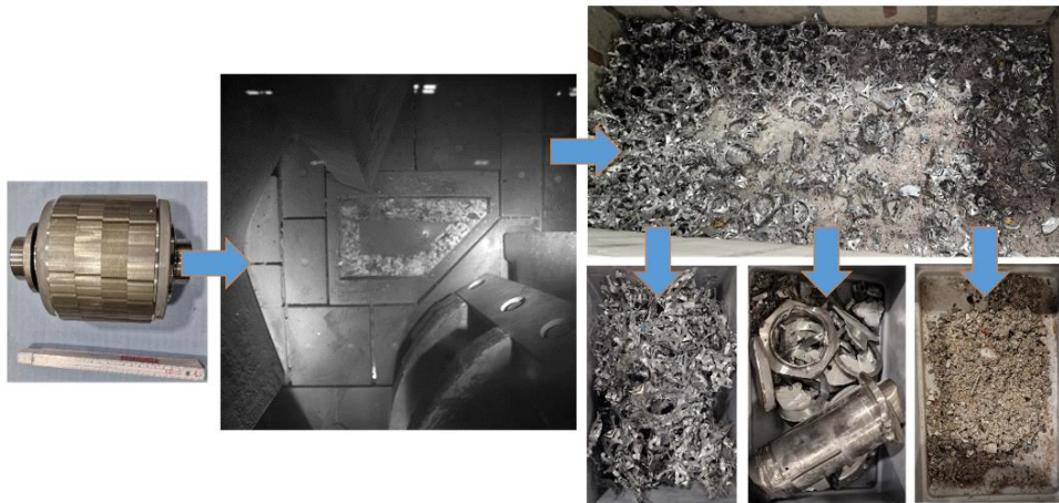
Abbildung 12: Die Zerkleinerung eines kompletten Rotors mit einer Prallmühle führt neben größeren Stahlfragmenten aufgrund der starken Kräfte im Inneren der Mühle zu einem groben Magnetpulver, welches mit anderen Materialien verunreinigt ist und daher für ein funktionales Recycling ungeeignet ist.
