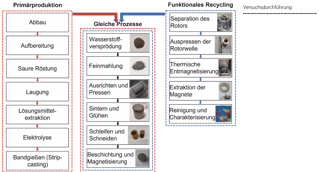
Abbildung 1: Prozessschritte zur Herstellung von gesinterten Nd-Fe-B-Magneten über die Primärroute (links) und die Recyclingroute aus einem Elektromotor (rechts).
