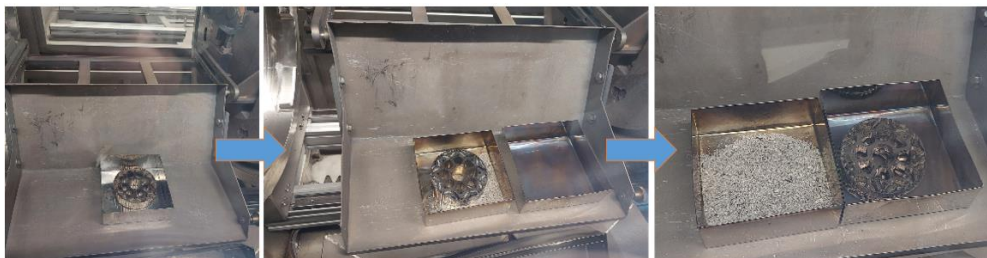
Abbildung 13: Direkte Wasserstoffversprödung der im Rotorblechpaket enthaltenen Magnete führt zu einer Trennung der Nd-Fe-B-Magnete (als Pulver) von den Stahlkomponenten.
